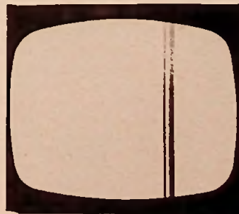
Bild 17. Barkhausen-Kurz-Schwingung auf dem Empfängerraster
