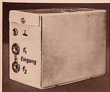
Bild 2. Das Äußere des Gerätes. Die beiden Eingangsbuchsen befinden sich auf der Vorderseite; ein Buchsenpaar auf der entgegengesetzten Seite dient zum Anschließen des Kopfhörers
